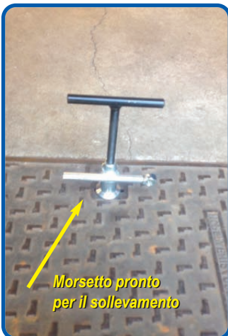
Fissaggio della barretta centrale nella posizione favorevole alla leva
